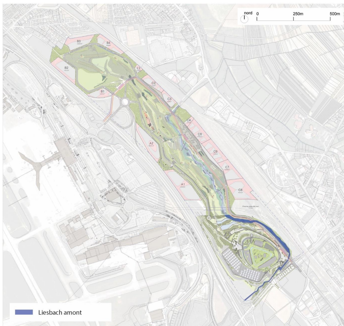
Plan de repérage de la portion amont du Liesbach renaturé – 1km de long
