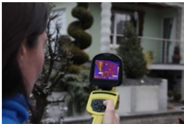
En pleine thermographie de façade, février 2018 - photo L'Alsace/Jean-Christophe Meyer.
