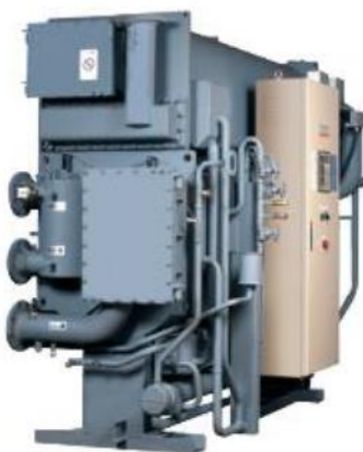
Machine à absorption permettant la production d'eau glacée ( 7/12^{\circ}\text{C} ) et d'eau tiède ( 35/30^{\circ}\text{C} ) à partir d'eau chaude ( >90^{\circ}\text{C} )
