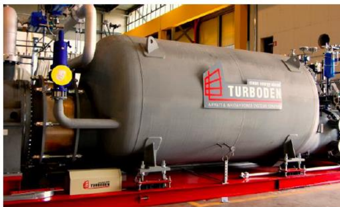
Cogénérateur à cycle combiné de Rankine permettant la production d'électricité et d'eau chaude ( 80/60^{\circ}\text{C} ) à partir de vapeur ( >300^{\circ}\text{C} )
