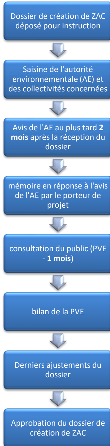
Figure 3 : Schématisation du processus d'évaluation environnementale dans le cadre de l'instruction du dossier de création de ZAC pour le projet
