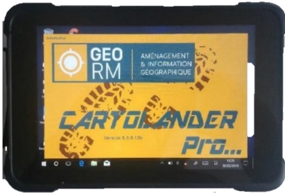
SIG mobile (tablette de terrain) équipée de CartoLander version Pro
