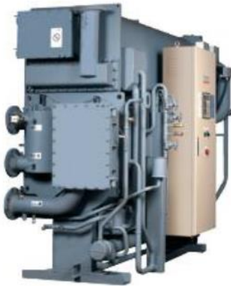
Machine à absorption permettant la production d'eau glacée (7/12°C) et d'eau tiède (35/30°C) à partir d'eau chaude (>90°C)
