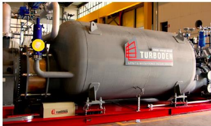
Cogénérateur à cycle combiné de Rankine permettant la production d'électricité et d'eau chaude (80/60°C) à partir de vapeur (>300°C)
